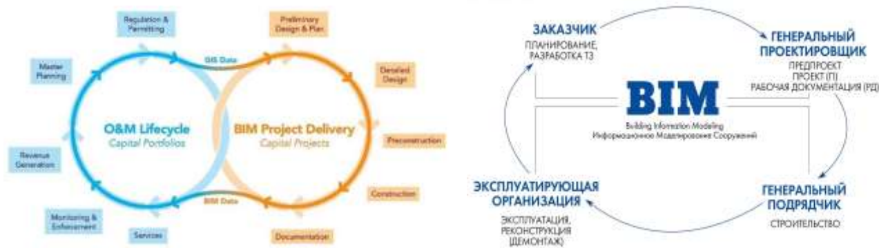
Рис.4 Принципиальная схема взаимодействия участников КЖЦ в ЕИП
